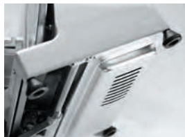
Motor refrigerado a ar protegido por tampa em metal
